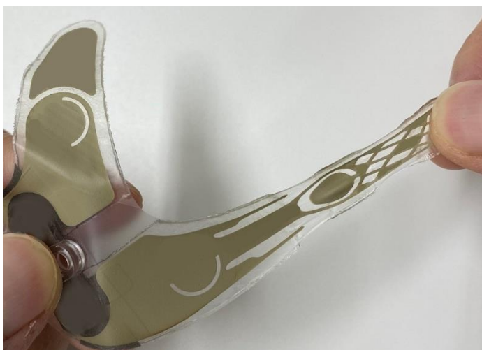
伸ばした状態のハイドロゲル付きストレッチャブル FPC(イメージ)
