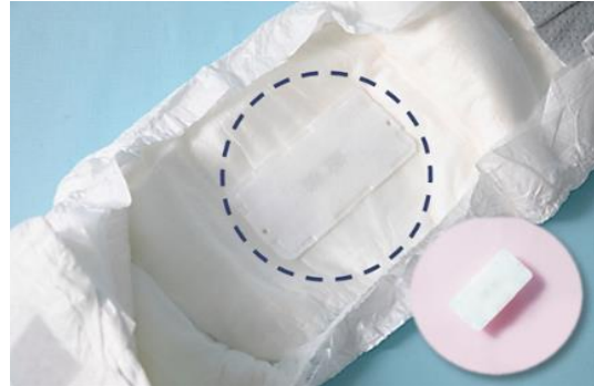
センサーを取り付けたオムツ。 センサーは名刺サイズの大きさです。
