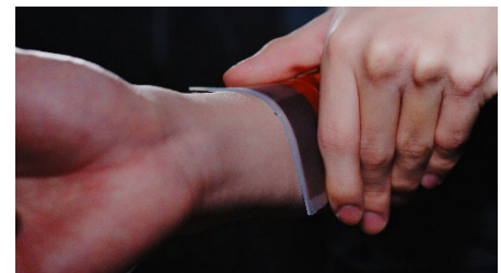
CAST社と共同開発した「フレキシブル超音波センサ」。柔軟性があり、腕の様な曲面にフィットします。
