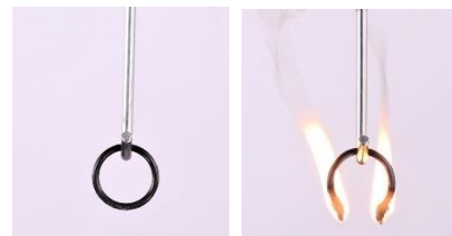
汎用 EPDM に比べ燃えにくいため、発燃する場所での使用が期待されます。 左：フラテクター 右：汎用 EPDM
