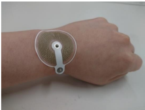
(写真1) 極薄伸縮コイルアンテナを装着した様子
