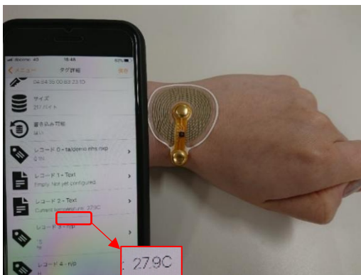
(写真 3) 非接触給電下でも外部機器と接続し温度を計測
