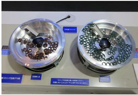
SP 処理を施した O リング(右)と通常タイプの O リング(左)の比較デモ機。チョコ停防止を可視化しています
