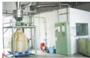
ゴムチップ生産室 粉砕機の入った粉砕室から出てきたチップはパイプを通して袋に詰め込まれる
