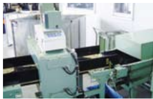
ゴムばりの粉砕作業 約30cmの黒いゴムばりが粉砕機へのコンベアに載せて投入される
